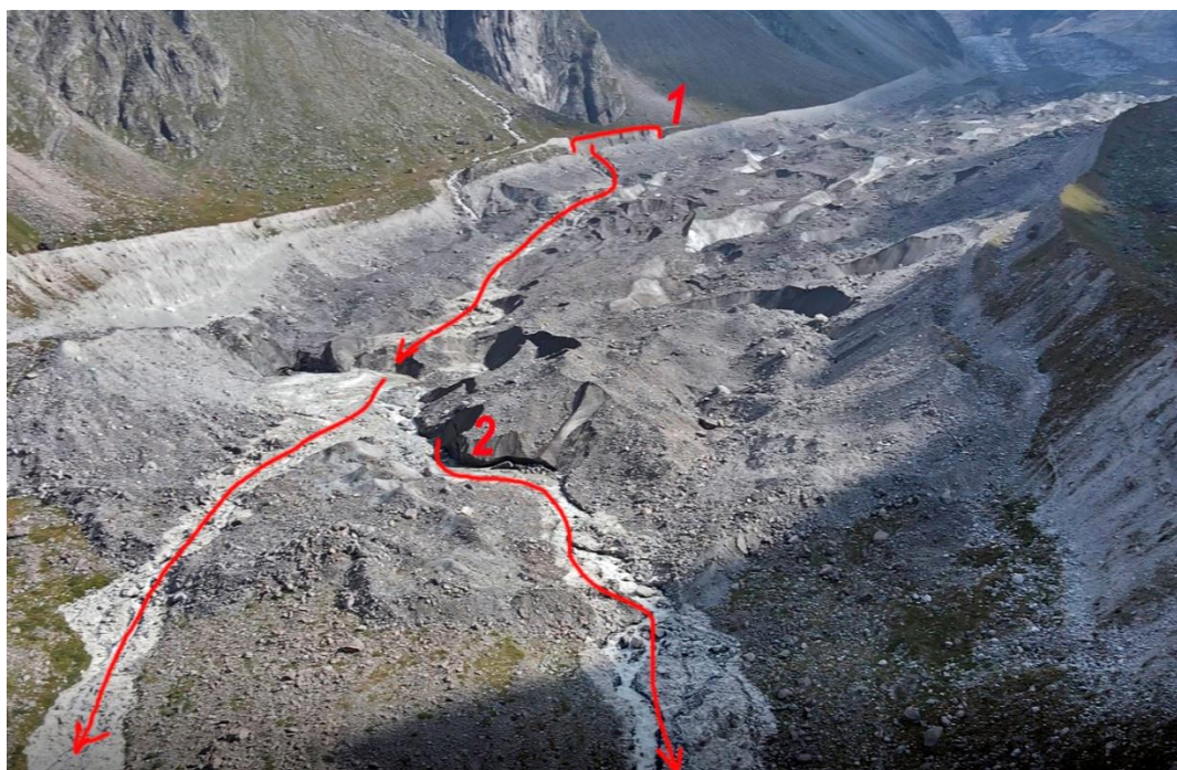
Рис. 1. Зона зарождения селя в верховьях долины р. Мижирги. Фото с квадрокоптера 23.08.2022. 1 – селевой очаг на правой береговой морене ледника Мижиргичиран, 2 – селевой очаг у конца ледника Мижиргичиран
