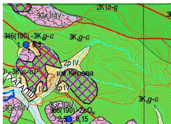
Рис. 5. Фрагмент гидрогеологической карты [Отчет ФЦП, 2007]. Бассейн реки Бжижу. Условные обозначения: 2pIV – пролювиальный голоценовый водоносный горизонт: щебнисто-глыбовые, валунные и глинисто-дресвяные отложения; 3K 1g-a – готеривско-аптский относительно водоупорный горизонт: глины, алеволиты, песчаники; 3Gr II-IV – нерасчлененный верхненеоплесточеново-голоценовый водоупорный горизонт гравитационного комплекса отложений, сложенный дресвяно-глинистыми отложениями с включением щебня, глыб, отторженцев, глин и суглинков. Остальные обозначения см. на рис. 3
