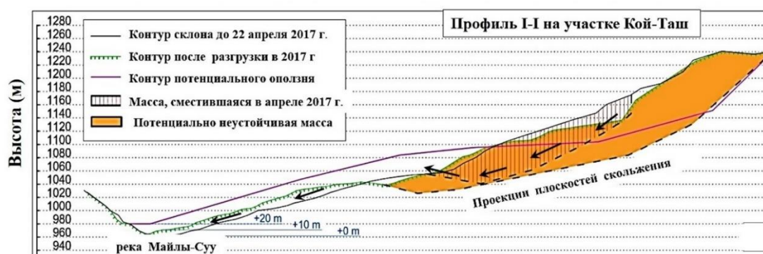
Рис. 4. Результаты моделирования оползневой дамбы в случае разгрузки оползня Кой-Таш: высота оползневой дамбы в русле р. Майлуу-Суу в апреле 2017 г. не превышала 10 м; при повторной разгрузке оползня объемом около 4 млн м 3 высота возможной дамбы может достигнуть 20 м
