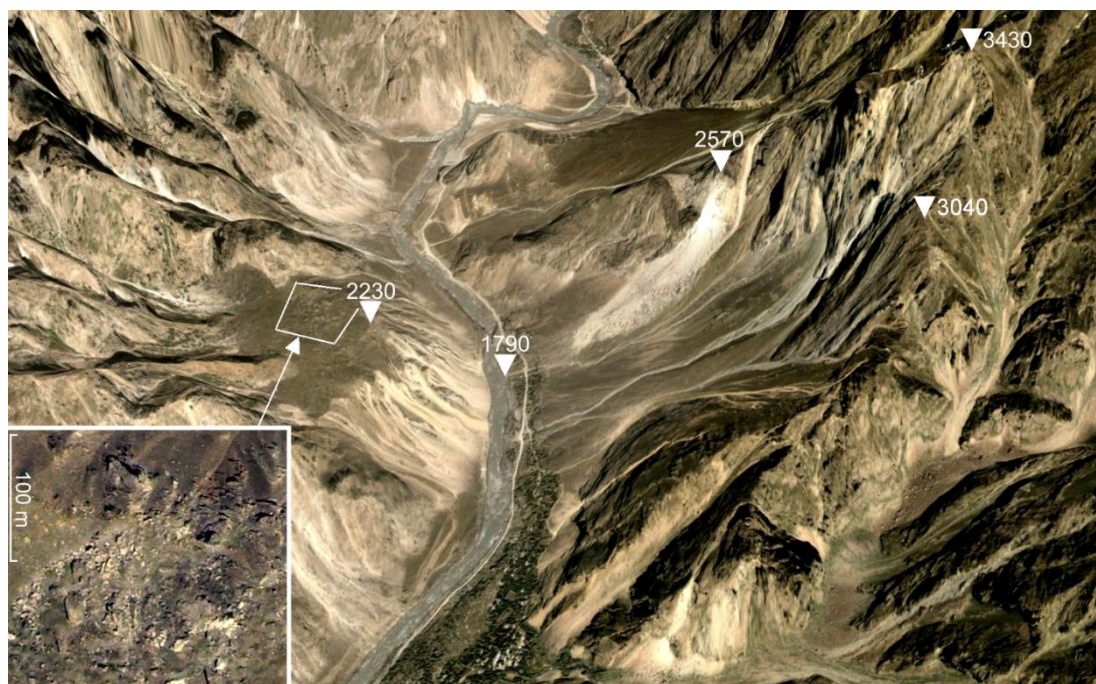
Рис. 7. Перспективное изображение Вознавдского оползня на космическом снимке из Google Earth. На врезке видны глыбы на поверхности оползневого тела на Афганской стороне долины р. Пяндж. Из работы [Strom, Abdrakhmatov, 2018] с разрешения издательства Elsevier
